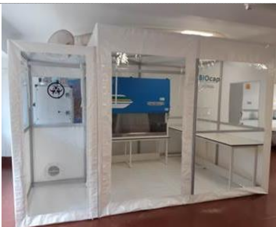
Prototype de Biocap en pression positive (protection de l'intérieur face à l'environnement)
